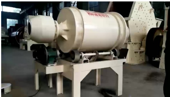
Рис. 1. Лабораторная роторно-шаровая мельница
